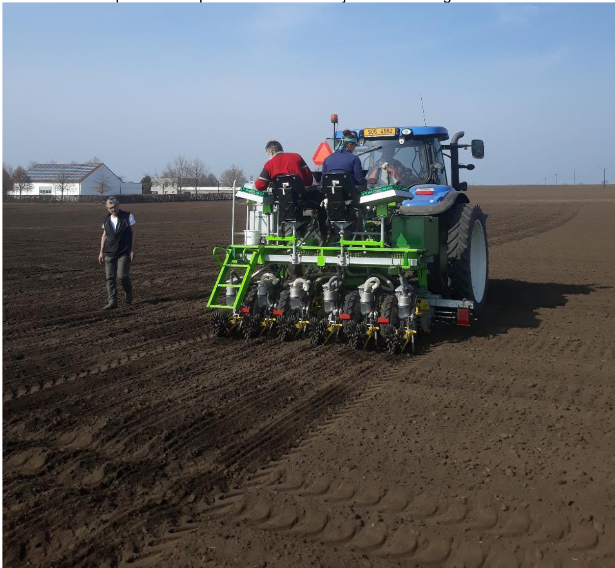
Obrázek 2: Setí pokusů se speciálním secím strojem Wintersteiger Monoseed K
