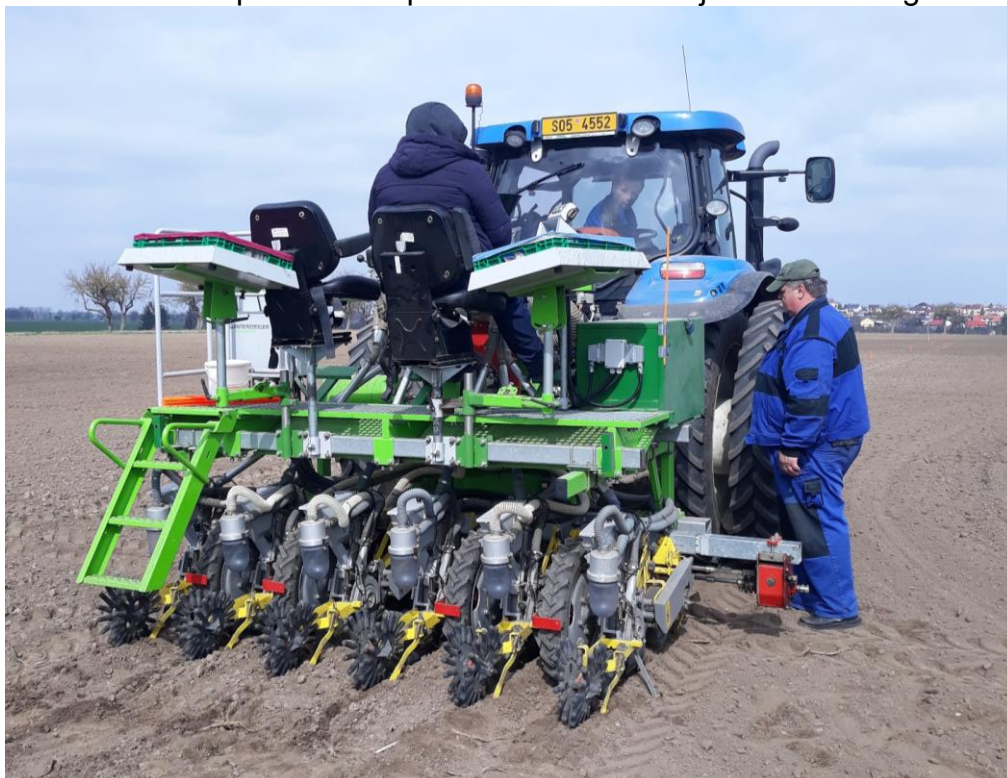
Obrázek 1: Setí pokusů se speciálním secím strojem Wintersteiger Monoseed K
